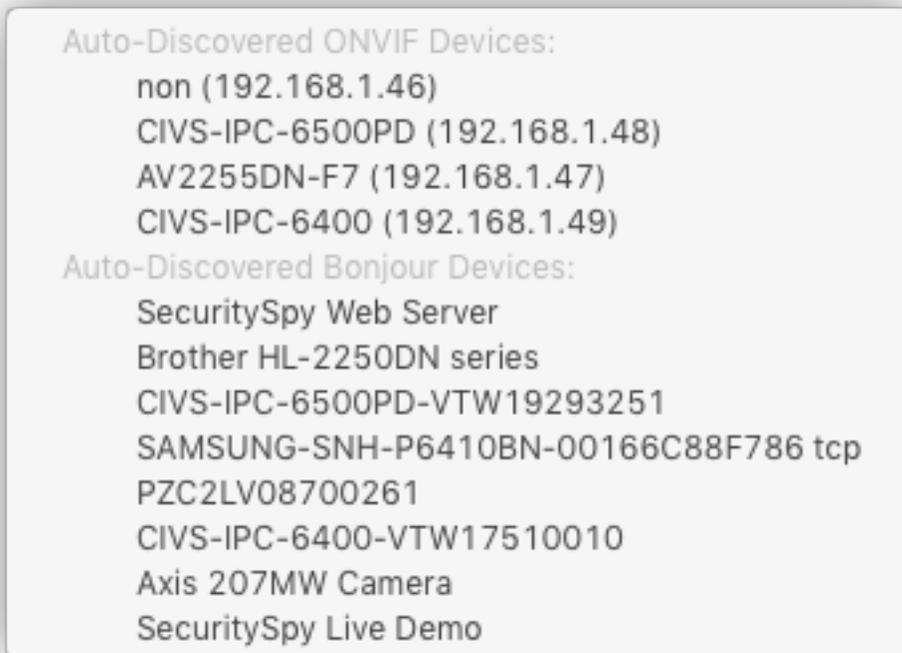
Seleccione un dispositivo de esta lista y el campo Dirección se completará automáticamente con la dirección del dispositivo seleccionado. Este menú consta de dos secciones: Dispositivos ONVIF: esta sección enumera todos los dispositivos ubicados a través del mecanismo de descubrimiento automático de ONVIF.
